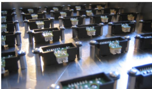
図 5. 上部パネル裏面に配置された赤外線センサ
