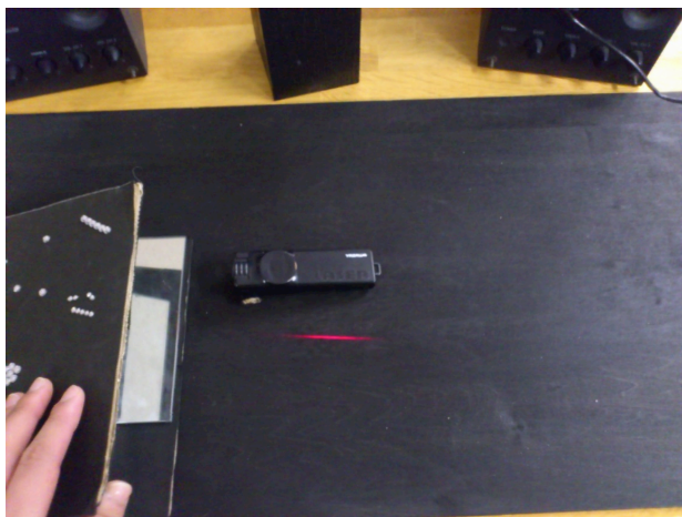
図 5. 鏡開閉による操作法
