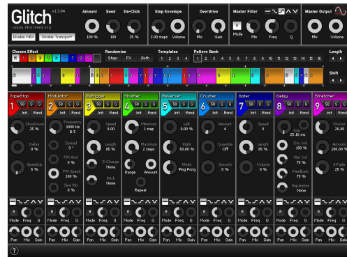
図2. VSTプラグインで実装されるマルチエフェクターの例 [2]
