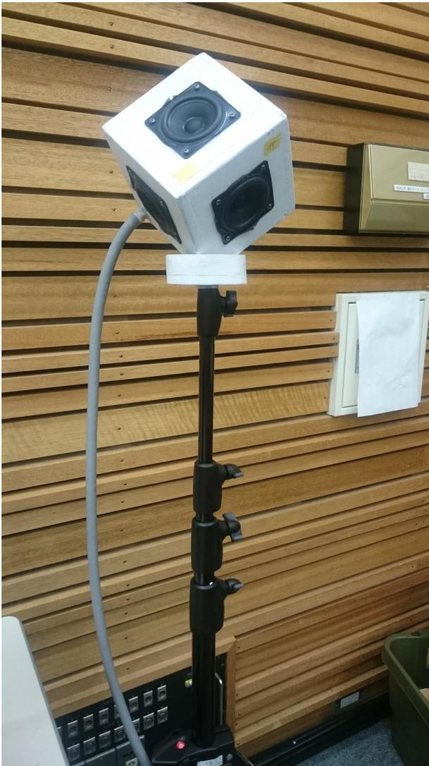
図 3. マルチチャンネル出力対応正 6 面体無指向性スピーカー
