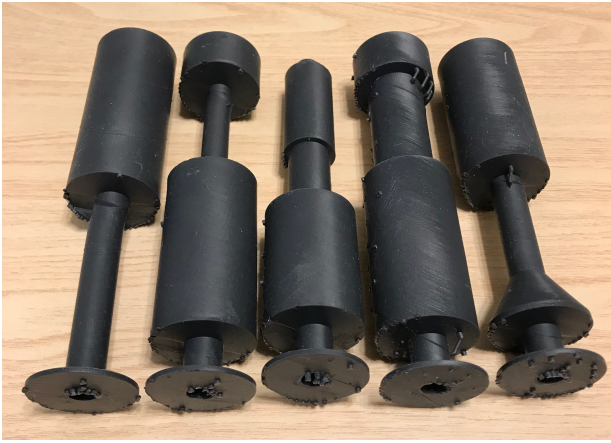
図 2: フレキシブル素材の声道模型
