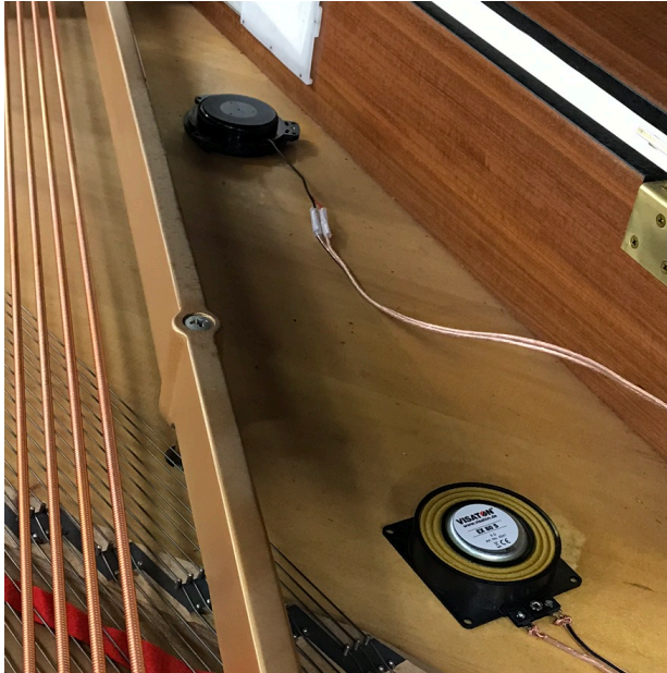
図 2: エキサイターを設置した様子
