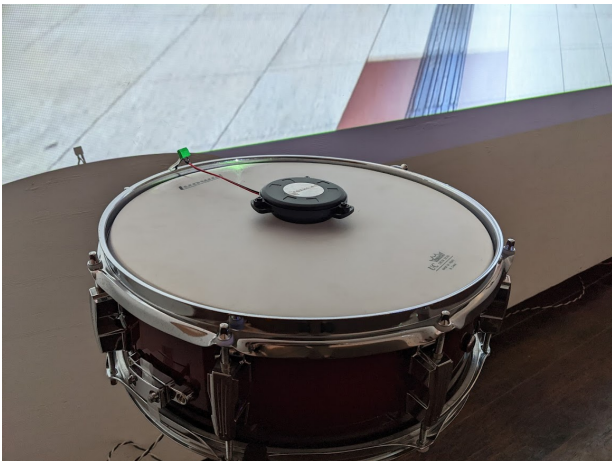
図 2: 振動スピーカーを取り付けたスネアドラム
