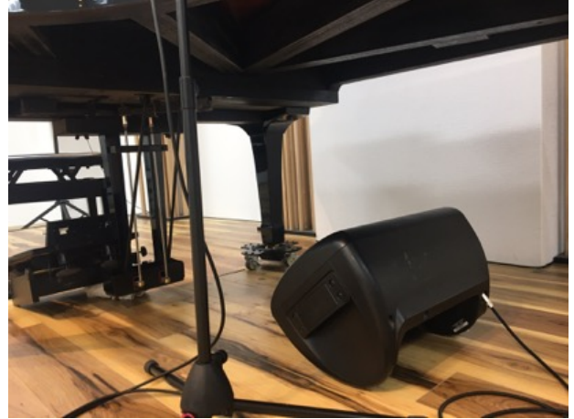
図3: ピアノの弦振動による反響音を発生させるためのセッティング。
