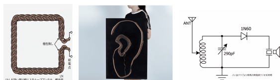
【図2:自作した耳型ループアンテナの回路図】
